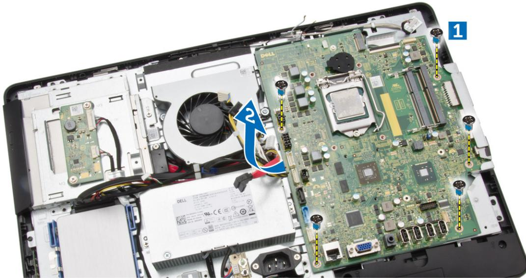
5. Entfernen Sie die Systemplatine aus dem Computer.
