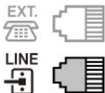
Lorsque vous connectez le téléphone à l'imprimante, vérifiez que l'imprimante est hors tension, branchez une extrémité du câble modulaire au connecteur de périphérique externe marqué « EXT. » sur l'imprimante, puis reliez l'autre extrémité au connecteur de ligne téléphonique du téléphone.
