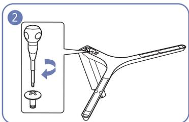
Ruotare completamente la vite di collegamento posta sul fondo del piedistallo in modo da fissarlo saldamente.
