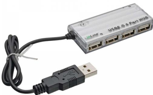
Der Mini USB Hub besitzt 4 USB Typ A Buchsen zum Anschluss von bis zu 4 USB 2.0 / 1.1 oder 1.0 Geräten. Dieser Hub wird passiv (Bus-powered) betrieben, d.h. es wird kein externes Netzteil benötigt. Die angeschlossenen Geräte sollten zusammen nicht über 500mA Strom benötigen, bzw. eine eigene Stromversorgung haben. Der Pocket Mini USB Hub hat ein integriertes USB 2.0 Anschlusskabel.
