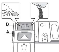
**La funzione A serve per l'apertura del dosatore del detersivo**
