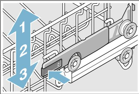
4. Oberen Geschirrkorb **anheben**; oberen Geschirrkorb am oberen Rand fassen und anheben.
