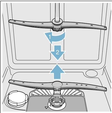
4. Sprüharme unter fließendem Wasser reinigen.
