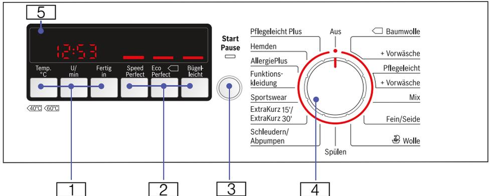
**1** Temp. °C. (Temperatur), **U/min** (Schleuderdrehzahl), **Fertig in**-Zeit zum Ändern der Programm-Voreinstellungen
