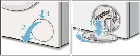
4. Entleerungsschlauch aus der Halterung nehmen. Verschlusskappe abziehen, Lauge in geeignetes Gefäß abfließen lassen. Verschlusskappe aufdrücken und Entleerungsschlauch in die Halterung einsetzen.
