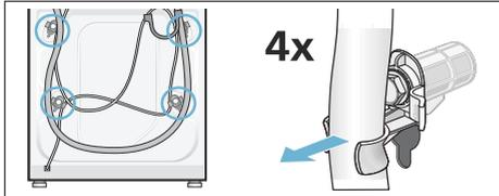
2. Alle 4 Transportsicherungsschrauben lösen und entfernen. Dabei Netzleitung aus den Halterungen nehmen.
