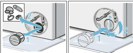
6. Service-Klappe einsetzen, einrasten und schließen.
