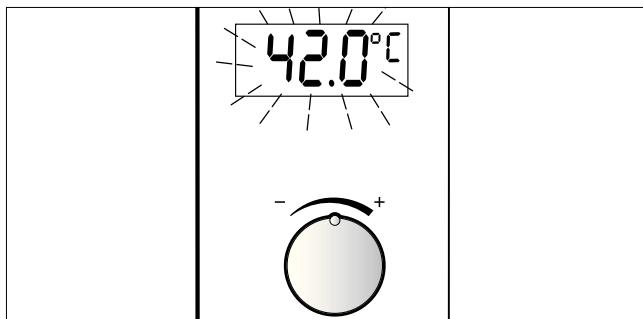
La température d'arrivée de l'installation domestique est trop élevée, par ex. par le biais de l'eau depuis une installation solaire.
