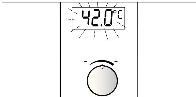
De toevoertemperatuur uit de huisinstallatie is te hoog, bijvoorbeeld door water uit zonne-energie.
