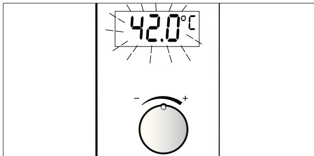
Die Zulauftemperatur aus der Hausanlage ist zu hoch, z. B. durch Wasser aus einer Solaranlage.
