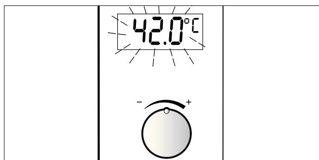
Temperatura zasilania z instalacji domowej jest za wysoka, np. przez dopływ wody z instalacji słonecznej.
