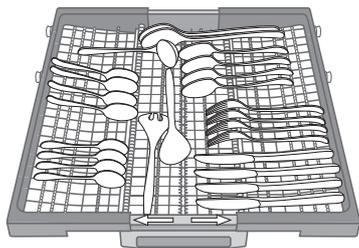
Il terzo cestello è stato progettato per alloggiare le posate durante il lavaggio.
