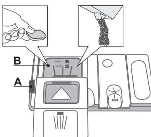
**Per aprire il distributore del detersivo utilizzare il dispositivo di apertura A. Versare il detersivo solo nel distributore B asciutto. Mettere la dose di detersivo per il prelavaggio direttamente all'interno del distributore.**
