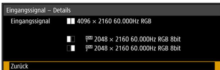
In dem obigen Beispiel hat das HDMI-1/2-Eingangssignal eine Auflösung von 2048 x 2160, eine vertikale Frequenz von 60 Hz, das Farbformat RGB und eine Farbtiefe von 8 Bit.
