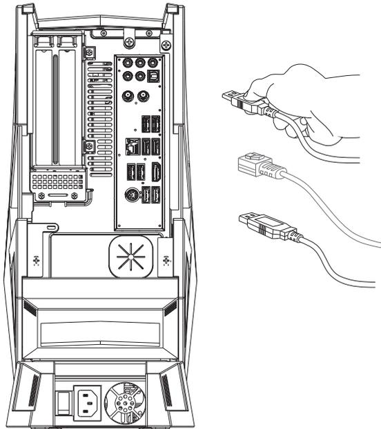
2. Connectez le câble d'alimentation à la prise de l'appareil et à la prise électrique.
