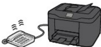
L'imprimante reçoit automatiquement le fax si elle détermine que la sonnerie correspond à un fax.
