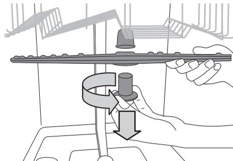
Per rimuovere l'irroratore superiore, ruotare la ghiera di bloccaggio in plastica nel verso antiorario. Il braccio irroratore superiore dev'essere posizionato in modo che il lato con più fori sia rivolto verso l'alto.
