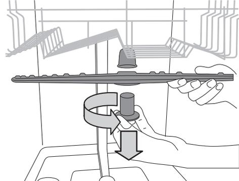
Per smontare il braccio aspersore superiore, ruotare l'anello di bloccaggio in plastica in senso antiorario. Il rimontaggio del braccio aspersore deve avvenire in modo che il lato con il maggior numero di fori sia rivolto verso l'alto.
