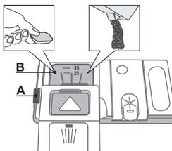
**Per aprire il distributore detersivo utilizzare il dispositivo di apertura A.**
