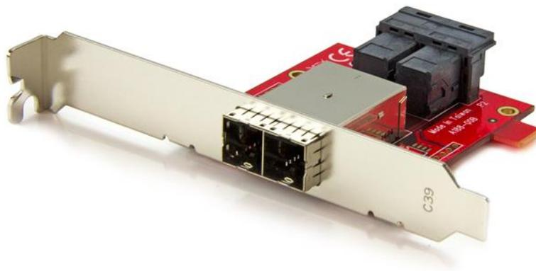
Cet adaptateur Mini-SAS vous permet de convertir deux ports internes SFF-8643 sur une carte contrôleur en deux ports externes SFF-8644. Cela vous permet de connecter les disques SAS ou SATA externes d'appareils de type Direct Attached Storage (DAS) à un backplane interne ou un contrôleur SAS pour obtenir du stockage supplémentaire.
