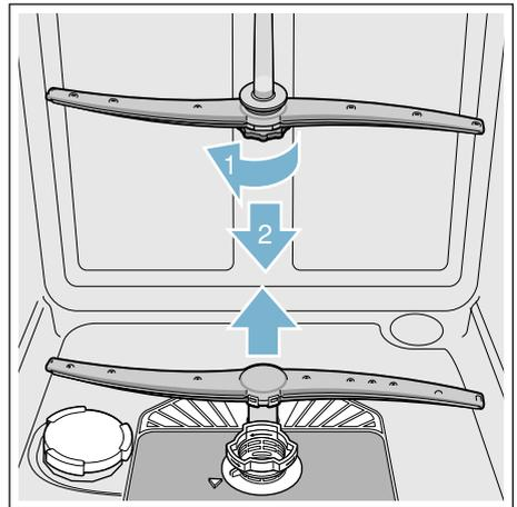
4. Sprüharme unter fließendem Wasser reinigen.
