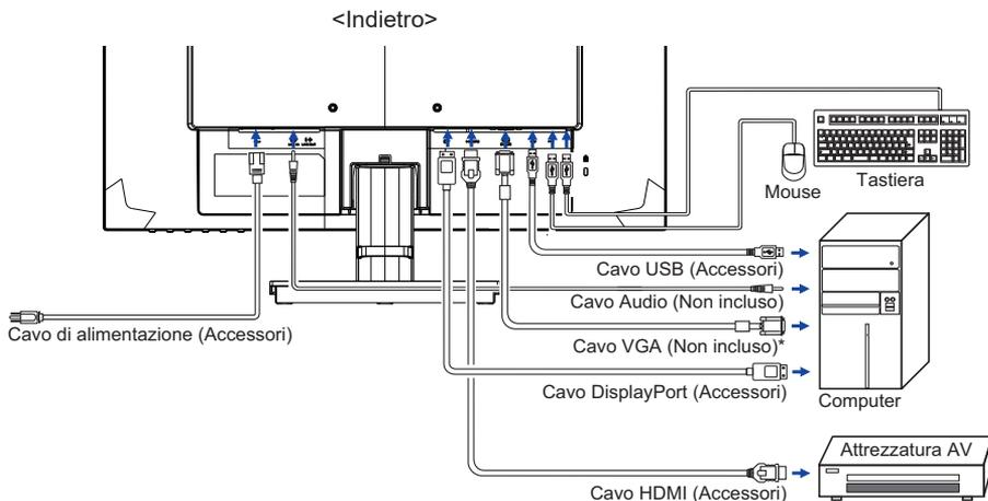
\* Il cavo VGA non è fornito con il monitor. Se usate un cavo VGA di scarsa qualità si potrebbero avere interferenze elettromagnetiche. Si prega di contattare il Centro di Supporto di Iiyama nel vostro paese se si desidera collegare il monitor tramite l'ingresso VGA.
