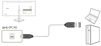
Branchez le câble USB au port 🖺 situé au dos du produit et au port USB 🔙 du PC.
