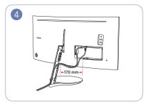
Assurez-vous que la longueur des câbles, dans la plage indiquée dans l'image, est d'au moins 170 mm, de sorte qu'il y ait du jeu dans les câbles. Des câbles serrés rendent la fixation du CAPOT GAUCHE DU COL DE SOCLE difficile.
