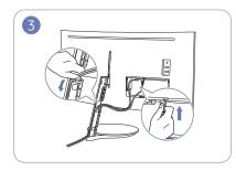
Connectez les câbles aux ports appropriés. Passez les câbles par l'ouverture du socle, comme illustré.
