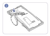
Fixez le socle à l'arrière du moniteur dans le sens de la flèche.
