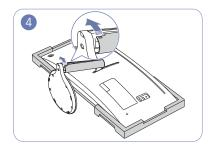
Tenez le socle d'une main et utilisez l'autre main pour fixer le CAPOT GAUCHE DU COL DE SOCLE dans le sens de la flèche.
