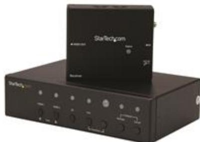
Questo kit extender video multi-ingresso utilizza la tecnologia HDBaseT™ per estendere i segnali video fino a 70 metri, utilizzando un solo cavo CAT5e o CAT6. È dotato di uno switch video integrato che consente di scegliere quale sorgente video trasmettere tramite le quattro sorgenti video indipendenti (2 HDMI, 1 VGA e 1 DisplayPort). L'extender video supporta risoluzioni Ultra HD 4K e Full HD 1080p, con supporto per il relativo audio digitale 7.1.
