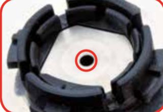
Voordat u de bal opnieuw installeert dient u na te gaan of de buis niet geblokkeerd is door er in te blazen.
