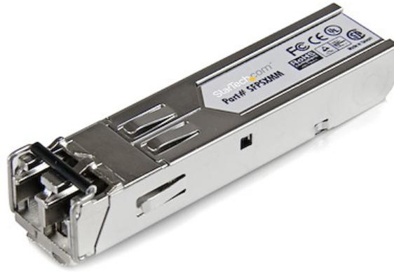
Le SFPSXMM est un transceiver SFP à fibre optique, conforme aux exigences TAA et aux normes MSA, qui est conçu, programmé et testé pour fonctionner avec des commutateurs et routeurs 1000BASE-SX conformes aux normes MSA. Le module de transceiver SFP prend en charge une distance maximale de 550 m et fournit une connectivité 10 GbE fiable via un câblage de fibre optique. <b>Spécifications techniques : </b>
