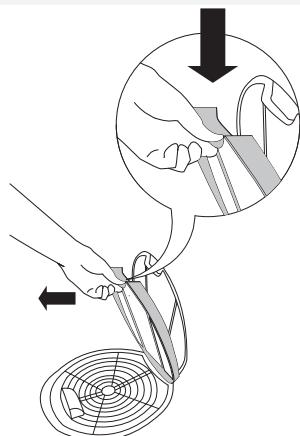
4. Avec votre main ou un chiffon doux, retirez les peluches des deux côtés du filtre. Si nécessaire, enlevez tous les résidus avec une éponge humide et un peu de liquide à vaisselle, puis essuyez soigneusement le filtre avec un torchon.
