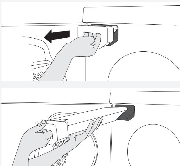
Si vous n'avez pas raccordé la machine à une évacuation distincte, le réservoir d'eau de condensation doit être vidé après chaque charge. Retirez le réservoir, videz-le et remettez-le en place.
