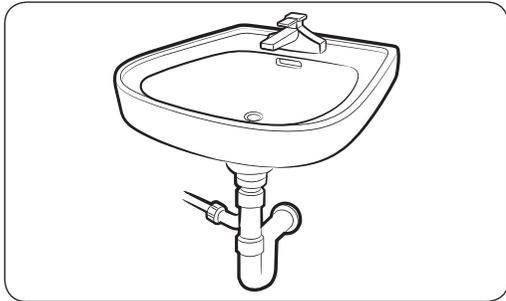
2. Sluit het uiteinde van de slang aan op de afvoerpijp.
