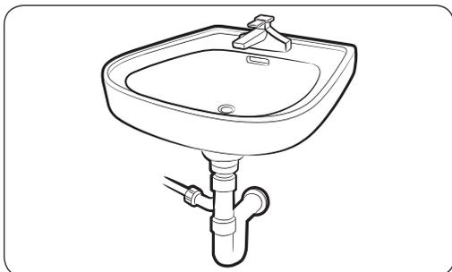
2. Schließen Sie das Schlauchende an den Abwasserstutzen an.
