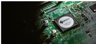
Der CG2730 verfügt über einen hochwertigen Microchip (ASIC, Application-Specific Integrated Circuit), den EIZO speziell für die besonderen Anforderungen des farbverbindlichen Arbeitens entwickelt hat. Mit einem eigenen Algorithmus sorgen EIZO ASICs für eine präzise, einheitliche und konstante Farbdarstellung.
