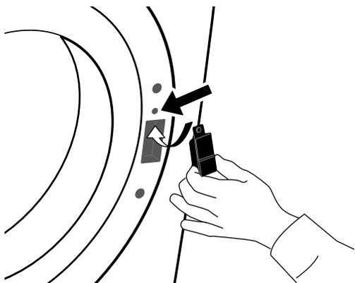
**19.** Inserire le due viti sopra e sotto il blocco
