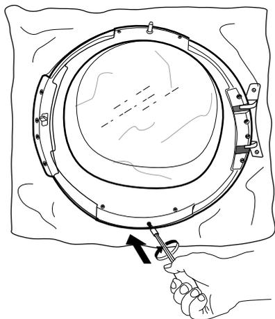
**18.** Inserire il blocco serratura sulla destra
