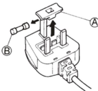
1. Rimuovere il coperchio del fusibile (A) e il fusibile (B).
