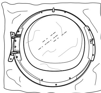
**5.** Rimuovere la vite inferiore per sbloccare il telaio di copertura sul lato anteriore dello sportello.
