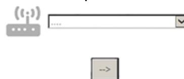
Se la rete wireless domestica è nascosta, selezionare "Altre" (->) e inserire manualmente il nome della rete (SSID) e il protocollo di sicurezza.
