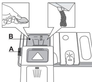
**Per aprire il distributore detersivo utilizzare il dispositivo di apertura A. Versare il detersivo esclusivamente nel distributore B asciutto. Mettere le dosi di detersivo per il prelavaggio direttamente all'interno del distributore.**
