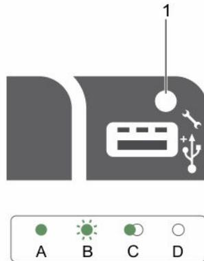
**Abbildung 13. iDRAC Direct-LED-Anzeige**
