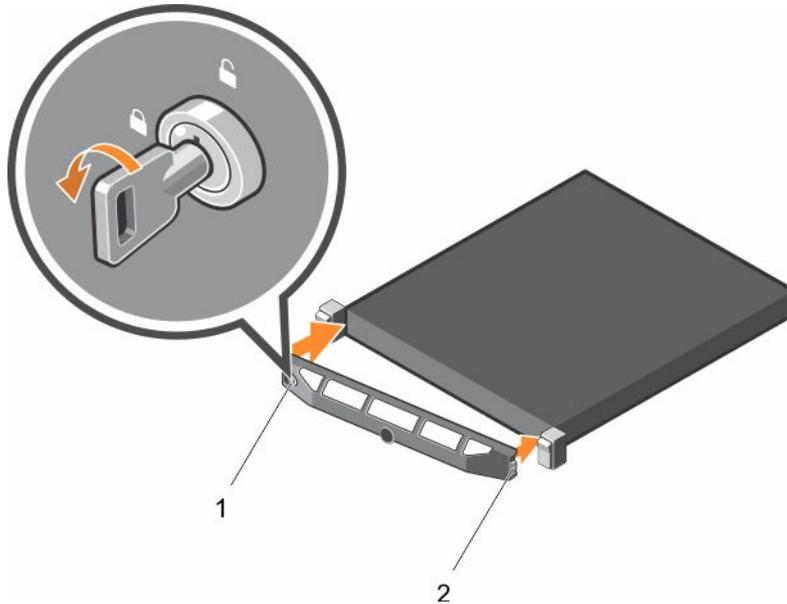
**Figure 18. Installing the optional front bezel**
