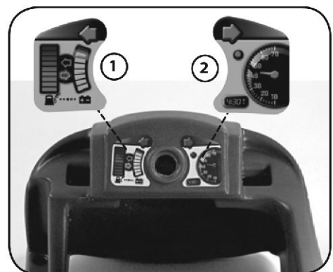
Apply decals 1 & 2 to dashboard. Appelez les autocollants n°s 1 et 2 sur le tableau de bord. Aplique las calcomanías 1 y 2 en el tablero de instrumentos.
