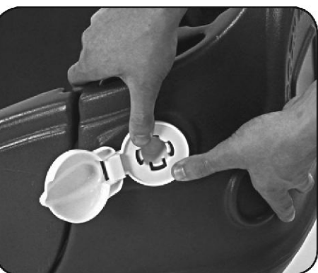
Insert gas cap. Insérez le bouchon de réservoir d'essence. Inserte la tapa de gasolina.
