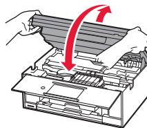
Wenn eine Fehlermeldung angezeigt wird, stellen Sie sicher, dass die Tintenbehälter ordnungsgemäß eingesetzt sind.
