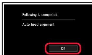
**Die Druckkopfausrichtung ist jetzt abgeschlossen.**
