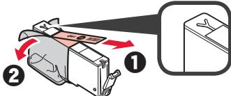
Entfernen Sie das orangefarbene Klebeband vollständig.
