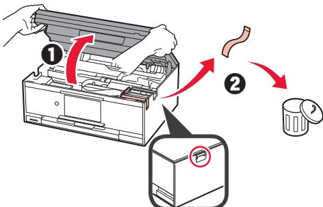
**3** HEBEN Sie das Scan-Modul/die Abdeckung AN und schließen Sie es/sie dann.
