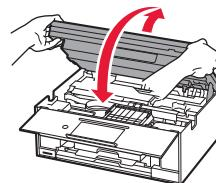
Hvis det vises en feilmelding, kontrollerer du at blekkankene er riktig installert.
