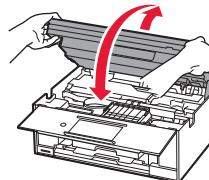
Se viene visualizzato un messaggio di errore, assicurarsi che i serbatoi d'inchiostro siano installati correttamente.
