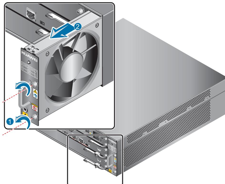
**Step 3** Install a new fan module.
