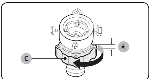
3. Afferrare l'adattatore e ruotare il **componente (C)** nella direzione della freccia per allentarlo di 5 mm (\*).
