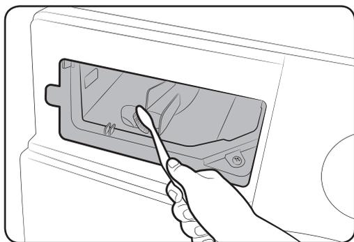
4. Pulire l'alloggiamento della vaschetta in acqua corrente utilizzando una spazzola morbida.
