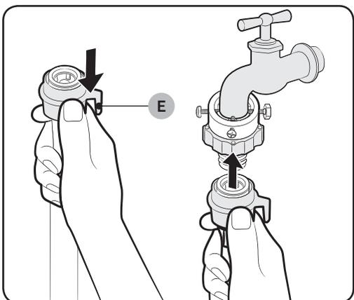
6. Tenendo premuto il **componente (E)**, collegare il tubo di carico dell'acqua all'adattatore. Quindi, rilasciare il **componente (E)**. Il tubo si inserisce nell'adattatore con un clic.
