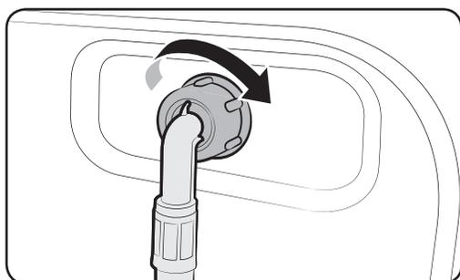
8. Collegare l'altro capo del tubo di carico dell'acqua alla valvola di carico posta sul retro della lavabiancheria. Ruotare il tubo in senso orario per stringere.
