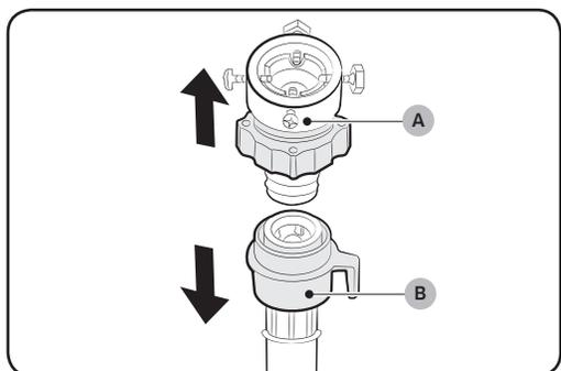
**Collegare il tubo di carico dell'acqua al rubinetto di carico dell'acqua.**
