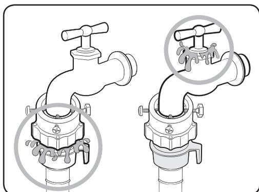
9. Aprire il rubinetto di carico dell'acqua e verificare la presenza di perdite intorno ai collegamenti. Se si riscontrano perdite d'acqua, ripetere i passaggi sopra descritti.
