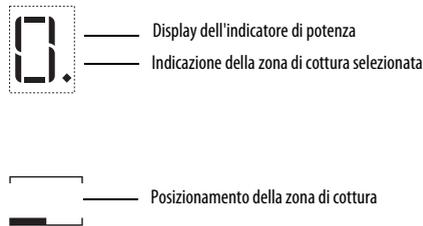
Funzionamento del dispositivo di scorrimento
