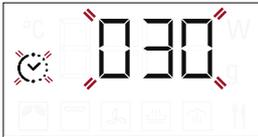
🕒 Quando l'icona lampeggia sul display, ruotare la *manopola di regolazione* per impostare il tempo di cottura desiderato.
