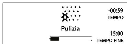
A ciclo ultimato, il relativo messaggio di avviso lampeggia sul display. La temperatura residua viene indicata sul display mentre la porta rimane bloccata fino a quando non viene raggiunta una temperatura sicura.
