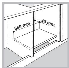
**!** É possível instalar o plano somente sobre fornos de encaixe equipados com ventilação de arrefecimento.
