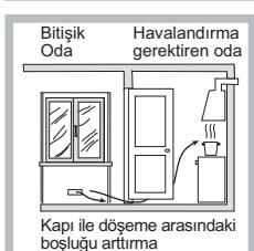
Veya, dolaylı olarak, bitişik mekânlarda mevcut olan yukarıda anlatılan türden bir dışarıya açılma sistemi bulunan bir havalandırma borusu kullanılabilir; bu havalandırma borusu gayri menkulün müşterek kullanılmında, ya da yanın tehlikesi olan mekânlarda ya da yatak odalarında olmamalıdır.
