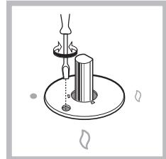
5. Als de regeling voltooid is moet u de zegels op de bypass schroefjes weer op hun plaats brengen met zegellak of dergelijk materiaal.
