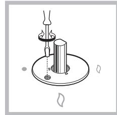
5. Après avoir procédé à ce réglage, reposez les scellés sur les by-pass en utilisant de la cire ou autre matériau équivalent.
