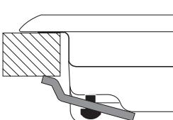
Posición del gancho para superficies  $H=20\text{mm}$
