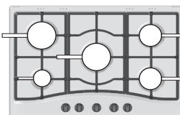
L'aspetto più variabile in termini di stabilità delle pentole può essere spesso la pentola stessa (o il suo posizionamento durante l'uso). Pentole ben bilanciate, con fondi piatti, centrate sul bruciatore, con le maniglie posizio- nate in linea con una delle razze della griglia offrono ovviamente la massima stabilità.
