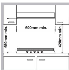
Siempre que la encimera se instale debajo de un armario de pared, éste último deberá mantener una distancia mínima de la superficie de trabajo de 700 mm.
