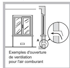
Le système peut être réalisé en prélevant l'air directement de l'extérieur du bâtiment au moyen d'un conduit d'au moins 100 cm<sup>2</sup> de section utile qui ne risque pas d'être bouché accidentellement.
