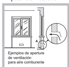
El sistema puede tomar aire del exterior del edificio a través de un conducto de  $100 \text{ cm}^2$ , como mínimo, de sección útil de modo que no pueda ser obstruido accidentalmente.
