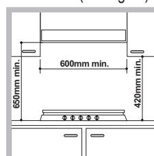
Allorchè il piano di cottura venga installato sotto un pensile, quest'ultimo dovrà mantenere una distanza minima dal top pari a 700 mm.
