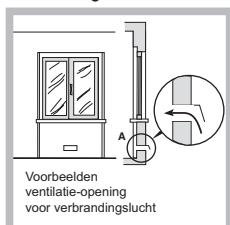
Dit systeem kan worden uitgevoerd door lucht direct van buiten te onttrekken door middel van een buis met een doorsnede van minstens  $100 \text{ cm}^2$  en die zodanig is geplaatst dat hij niet per ongeluk verstopt kan raken.
