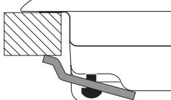
Çalışma tezgâhı için kanca pozisyonu  $H=20\text{mm}$
