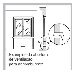
O sistema pode ser realizado capturando o ar directamente desde a parte externa do edifício através de um tubo de pelo menos  $100 \text{ cm}^2$  de secção útil que não se entupa accidentalmente.
