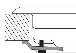
Posición del gancho para superficies  $H=30\text{mm}$
