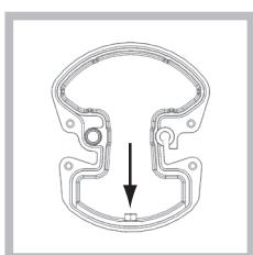
En el caso del quemador Mini WOK, para aflojar la tobera utilizar una llave abierta de 7mm (ver figura).
