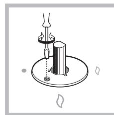
5. Nach erfolgter Neuregelung sind die auf den Bypass-Linien angebrachten Siegel mit Siegellack oder ähnlichem Material zu erneuern.
