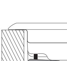
Çalışma tezgâhı için kanca pozisyonu  $H=40\text{mm}$
