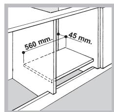
! Die Kochmulde darf nur dann über Einbaubacköfen installiert werden, wenn diese über ein Kühlgebläse verfügen.
