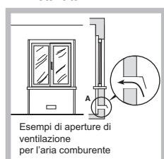
Il sistema può essere realizzato prelevando direttamente l'aria dall'esterno dell'edificio tramite un condotto di almeno  $100 \text{ cm}^2$  di sezione utile e tale che non possa essere accidentalmente ostruito.
