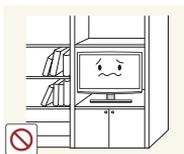
Non installare il prodotto in una posizione scarsamente ventilata, ad esempio una libreria o all'interno di un armadio.
