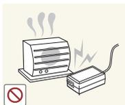
Tenere l'adattatore di corrente lontano da qualsiasi fonte di calore.
