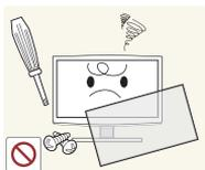
Poiché all'interno del prodotto è presente una corrente a elevato voltaggio, non disassemblare, riparare o modificare autonomamente il prodotto.
