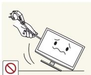
Non spostare il prodotto tirandolo per il cavo di alimentazione o il cavo dell'antenna.
