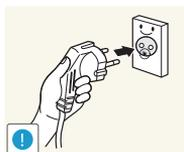
Collegare la spina di alimentazione a una presa di corrente dotata di messa a terra (solo per apparecchi con classe di isolamento 1).
