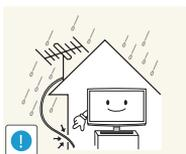
Piegare il cavo dell'antenna verso il basso nel punto in cui entra nell'alloggiamento in modo da non permettere l'ingresso di acqua piovana.
