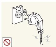
Non utilizzare un cavo di alimentazione o una spina danneggiati o una presa di corrente non salda.
