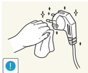
Se i poli della spina o la presa di corrente sono coperti di polvere, pulirli con un panno asciutto.
