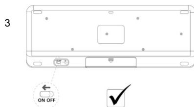
Schalten Sie die Funktastatur ein, indem Sie den Schieberegler auf der Unterseite der Tastatur auf „On“ schieben, wodurch gleichzeitig auch eine Funkverbindung aufgebaut wird.
