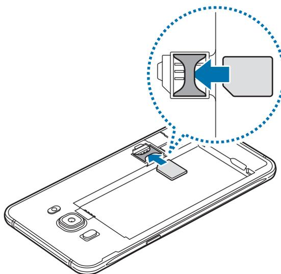
► **Modelli con SIM doppia:** inserite la scheda SIM o USIM nello slot come raffigurato di seguito.
