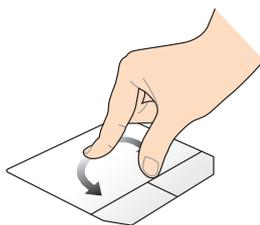
Para girar una imagen, coloque dos dedos sobre el panel táctil, a continuación, gire uno de los dedos en el sentido de las agujas del reloj o en el sentido contrario a las agujas del reloj sin desplazar el otro dedo.
