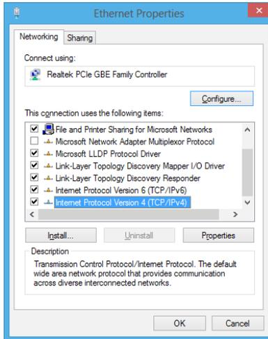
6. Pulse **Obtain an IP address automatically (Obtener una dirección IP automáticamente)** y luego pulse **OK (Aceptar)**.
