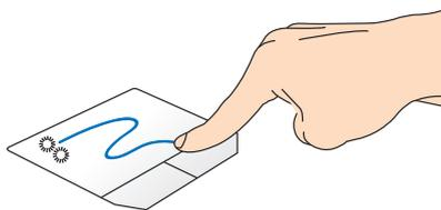
Pulse dos veces un elemento y deslice el mismo dedo sin levantarlo del panel táctil. Para ubicar el elemento en su nueva ubicación, levante el dedo del panel táctil.
