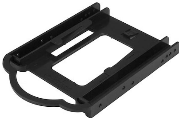
Ce support de fixation vous permet d'installer rapidement un SSD ou HDD 2,5" dans une seule baie 3,5" d'un PC de bureau ou serveur, sans aucun outil. Le support de fixation sans outils peut prendre en charge un SSD ou un disque dur 2,5" mesurant de 7 à 9,5 mm de hauteur.
