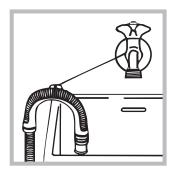
In alternativa, appoggiare il tubo di scarico al bordo di un lavandino o di una vasca, legando la guida (acquistabile presso il servizio assistenza) al rubinetto (vedi figura). L'estremità libera del tubo di scarico non
