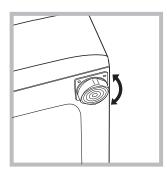
2. Compensare le irregolarità svitando o avvitando i piedini finchè la macchina non sia orizzontale (non deve essere inclinata più di 2 gradi).
