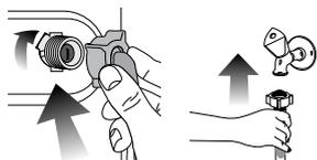
Aprire completamente i rubinetti dopo aver collegato il flessibile per controllare se ci sono perdite di acqua nei punti di connessione. In caso di perdite, chiudere il rubinetto e rimuovere il dado. Stringere nuovamente il dado dopo aver controllato la guarnizione. Per evitare perdite di acqua e danni conseguenti, tenere i rubinetti chiusi quando la lavatrice non è in uso.
