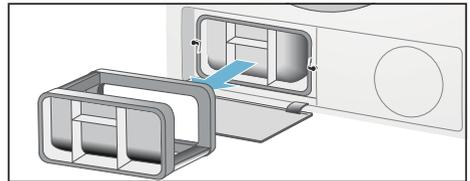
5. Entnehmen Sie den Wärmetauscher.
