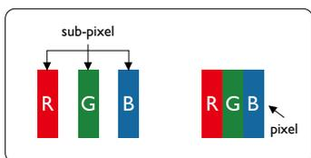
Un pixel, o elemento immagine, è composto di tre sub-pixel nei colori primari: rosso, verde e blu. Diversi pixel affiancati creano un'immagine. Quando tutti i sub-pixel di un pixel sono accesi, i tre sub-pixel colorati insieme creano un singolo pixel di colore bianco. Quando sono tutti spenti, i tre sub-pixel colorati insieme creano un singolo pixel di colore nero. Altre combinazioni di sub-pixel accesi e spenti creano singoli pixel di altri colori.
