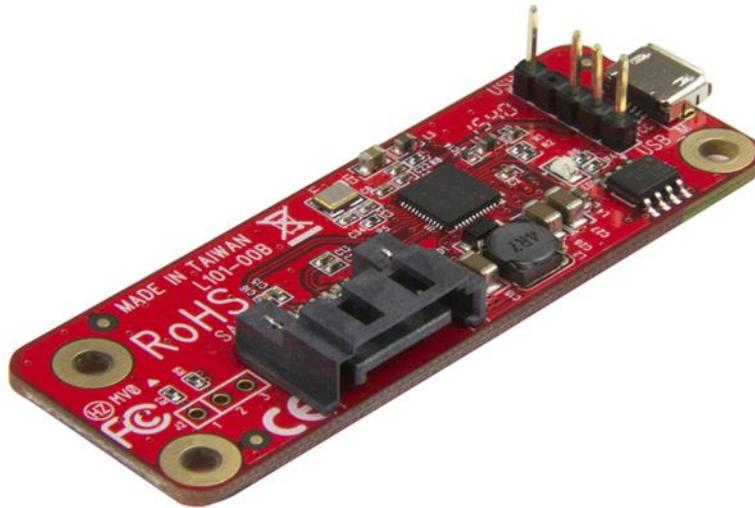
La connessione diretta a un'unità basata su SATA consente di aumentare la capacità di archiviazione dei dati di Raspberry Pi o di un'altra scheda di sviluppo. Ideale per la personalizzazione di progetti e applicazioni, questo convertitore USB a SATA supporta tutti i modelli Raspberry Pi, così come altre schede di sviluppo.
