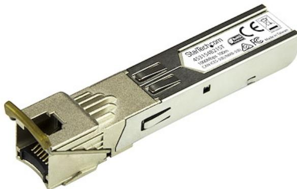
El modelo 453154B21ST es un módulo transceptor por cobre compatible con el modelo 453154-B21 de HPE, conforme a las normas TAA, diseñado, programado y probado para su funcionamiento con enrutadores y conmutadores de la marca HPE®. Ofrece conectividad 1GbE fiable a través de cable de cobre para redes compatibles con 1000BASE-T, con una distancia máxima de hasta 100m.
