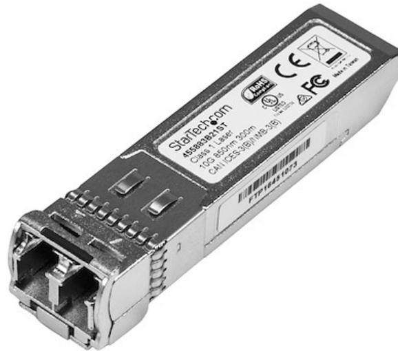
Das 455883B21ST ist ein TAA-konformes, HPE 455883-B21-kompatibles Glasfaser-Transceiver-Modul, das speziell für die Zusammenarbeit mit HPE®-Switches und -Routern entwickelt, programmiert und getestet wurde. Es liefert zuverlässige 10-GbE-Konnektivität über Glasfaserkabel für 10GBASE-SR-konforme Netzwerke mit einer maximalen Entfernung von bis zu 300 m.
