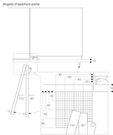
Il percorso della cerniera e le rispettive distanze dai mobili e dalle maniglie adiacenti possono essere dedotti dal disegno in base allo spessore del frontale. Nel disegno si prende in considerazione uno spessore del frontale di 19 mm.
