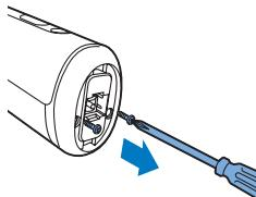
3 Retirez la partie inférieure de la poignée et coupez les deux fils connectés à la partie inférieure de l'appareil.
