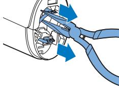
5 Estraete le batterie ricaricabili dall'apparecchio con delle pinze a becco lungo.
