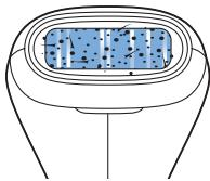
Hinweis: Ein verunreinigtes Lichtaustrittsfenster kann wie auf dieser Abbildung dargestellt aussehen. Stellen Sie sicher, dass Sie das Gerät nach und, falls erforderlich, auch während der Behandlung gemäß den Anweisungen in diesem Abschnitt reinigen.
