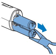
6 Tagliate i due fili uno alla volta per evitare incidenti a causa di possibili cariche residue
