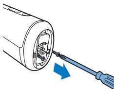
3 Rimuovete la parte inferiore dell'impugnatura e tagliate i due fili che collegano la parte inferiore all'apparecchio.
