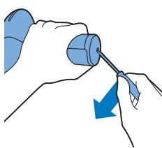
2 Svitate le due viti nella parte inferiore dell'impugnatura con un cacciavite.
